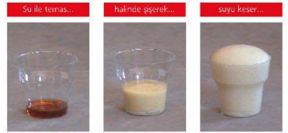
KÖSTER KB Pur IN 7 enjeksiyon reçinesi nemli veya ıslak çatlakların içine basınçlı şekilde enjekte edilir ve burada kalıcı elastik bir köpük oluşturarak su yalıtımı sağlar
