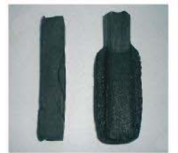
Bant su ile temas halinde genişleyerek (sağda) inşaat derzindeki boşlukları tıkar ve geçirimsizlik sağlar
